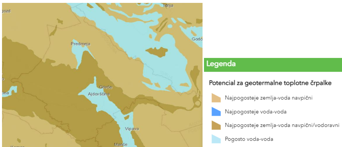
Slika 27: Potencial za uporabo geotermalnih toplotnih črpalk (Atlas trajnostne energije, 2022)
