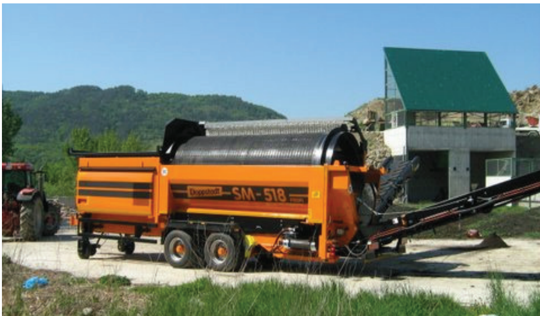
Premično rotacijsko sito Doppstadt SM 518 takoj po prihodu v CERO Ajdovščina pomladi 2011. Namenjeno je tako obdelavi mešanih komunalnih odpadkov kot obdelavi ločeno zbranih biorazgradljivih odpadkov iz gospodinjstev (rjave kante). Poleg sejanja naprava do neke mere tudi potrga plastične vrečke (noži montirani na notranjem obodu bobna).
